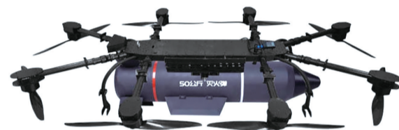
国产红翼先锋灭火无人机，拥有多达8个旋翼。
