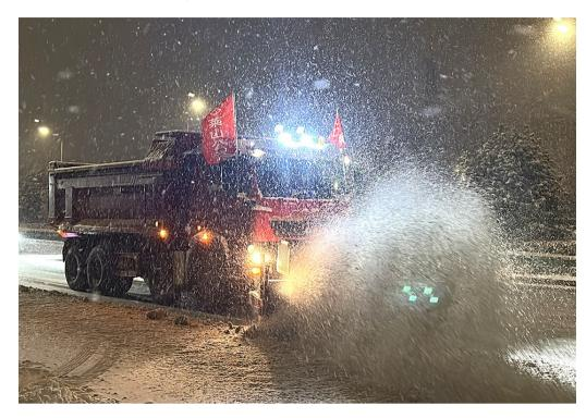
滑突击队采取"清雪滚刷+推雪铲+小型清雪机械+人工辅助"的方式,通过滚刷清除薄雪、推雪铲清除积雪、撒布车及时跟进抛撒防滑材料,安排专人在急弯陡坡等重要路段定点值守,全力做好所辖路段清雪
