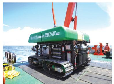
记者7月9日从上海市政府举办的发布会获悉，我国深海矿产资源开发关键技术与装备研制取得重大突破，由上海交通大学自主研制的深海重载作业采矿车工程样机“开拓二号”日前成功完成海试。“开拓二号”连续完成5次着底采矿，取回深海多金属结核壳与结核，实现深海重载作业采矿车海试水深首次突破4000米，最深达4102.8米，在国内首创深海复杂海底地形高机动行进、深海多矿类复合钻采等深海采矿领域多项技术。 据新华社
