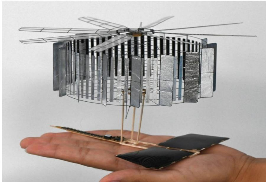
漆明净介绍,静电电机之所以能减少发热,是因为静电具有高电压、低电流的特性,电流越小,发热越少。“跟冬天穿衣服时的静电原理一致。衣服上静电的电压能达到上千伏甚至上万伏,但由于电荷少、电流小,产生的电功率小,对人体几乎无影响。”他说,团队专门研制出仅重1.13克的超轻
