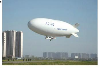
艇是基于已有飞艇的设计经验 和成熟技术成果研制的一款民 用载人飞艇,采用常规单囊体 布局、流线型气囊外形、四片 "X"型硬式梯形尾翼、单点单 支柱式不可收放起落架。
